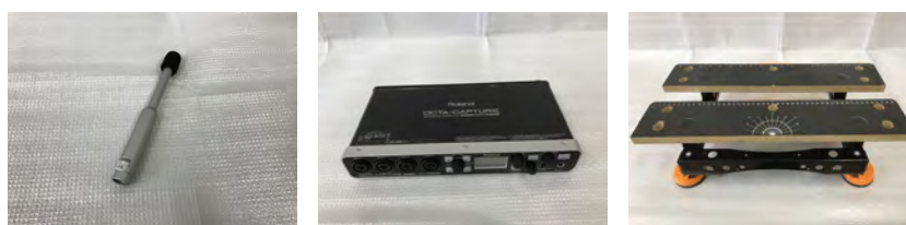
(e) マイクロフォン (ECM8000) (f) OCTA-CAPTURE (UA-1010 Roland) (g) 作業台
