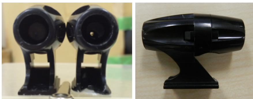
図 3.1: 鹿笛 RICHTER 社製試作成形品。左は鹿笛を前方(空気の当たる面)から見た画像で、その左が非貫通型、右が貫通型である。右は鹿笛を側面から見た画像で、右側が前方である。
